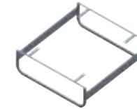
**Защитное устройство выносного испарителя**
